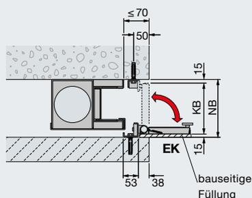
**Deckenklappen für den Sturzbereich**
