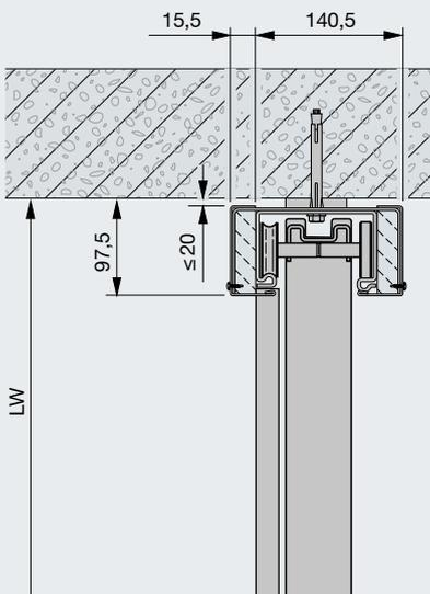
**Abgehängte Deckenmontage (bis max. 200 mm Gewindestangenlänge)**
