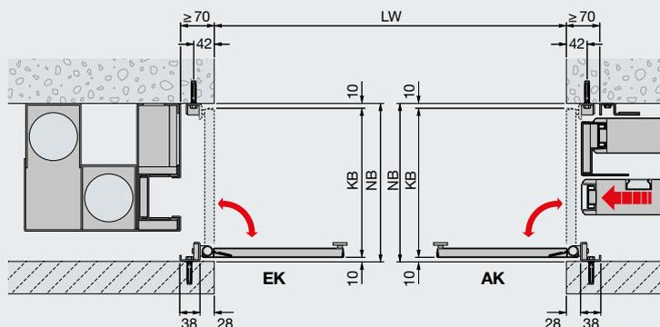
**Deckenklappen für den Sturzbereich**
