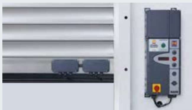
Funk-Übertragungseinheit Optionale Ausstattung zur Übertragung der Signale vom Torbehang via Bluetooth zur Steuerung – an Stelle einer Wendelleitung. Die Stromversorgung erfolgt über eine leistungsstarke Batterie. Für die Steuerungen: 445 R / 460 R
